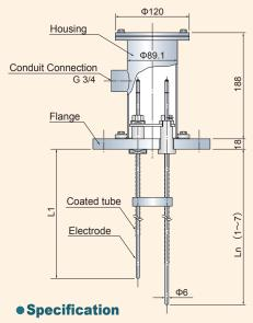
Diameter of Electrode : Φ6/ 8/ 10/ 15/ 20mm
